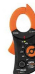
AC/DC lakatfogó, HT4006 • Méréstartomány: 0,1A÷40A AC/DC (40A tartomány) • Méréstartomány: 0,5A÷400A AC/DC (400A tartomány) • Alappontosság: ± 2,5% MÉ • Mérési kategória: CAT III 600V, CAT IV 300V a földhöz • Max kábel átmér : 30mm • Kimeneti csatlakozó: biztonsági banán, kábelhossz 1m
